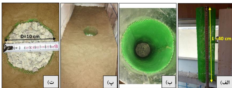
شکل ۷. مراحل اجرای ستون سنگی مسلح: الف) آماده‌سازی شبکه مسلح‌کننده ستون سنگی، ب) قرار دادن شبکه آماده شده در داخل استوانه فلزی فرو شده در خاک و ریختن و کوبیدن مصالح ستون سنگی در لایه‌های ۵ سانتی‌متری، پ) ستون اجرا شده در لایه یکی مانده به آخر، ت) ستون سنگی تکمیل شده و کنترل قطر ستون اجرا شده
