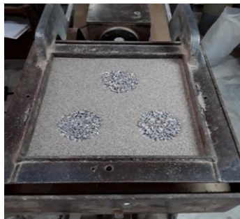
شکل ۶. آرایش قرارگیری ستون‌های سنگی در آرایش مثلثی الف) ۸/۴٪، ب) ۱۲٪، ج) ۱۶/۴٪
