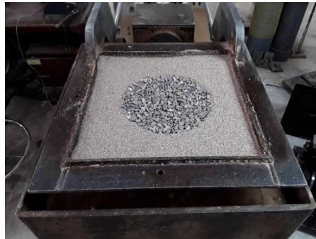
شکل ۴. آرایش قرارگیری ستون‌های سنگی منفرد (الف) ۸/۴٪، (ب) ۱۲٪، (ج) ۱۶/۴٪، (د) ۲۵٪
