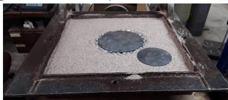
شکل ۹. آرایش قرارگیری ستون‌های سنگی منفرد (الف) ۸/۴٪، (ب) ۱۲٪، (ج) ۱۶/۴٪، (د) نمونه ساخته شده در دستگاه برش مستقیم
