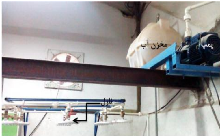
شکل ۴. بخش‌های مختلف دستگاه شبیه‌ساز باران استفاده شده
