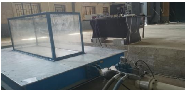
شکل ۱. محفظه مدل روی میز لرزه
