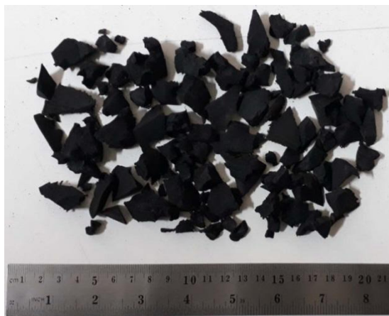
شکل ۲. خرده لاستیک دانه‌ای استفاده شده در آزمایش‌ها
