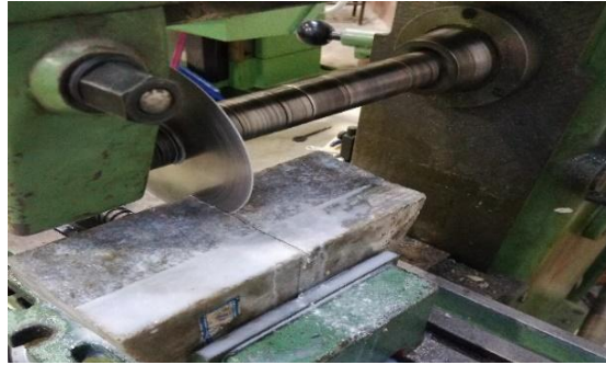
شکل ۳. نحوه ایجاد ترک در قطعات نیم‌دیسک
