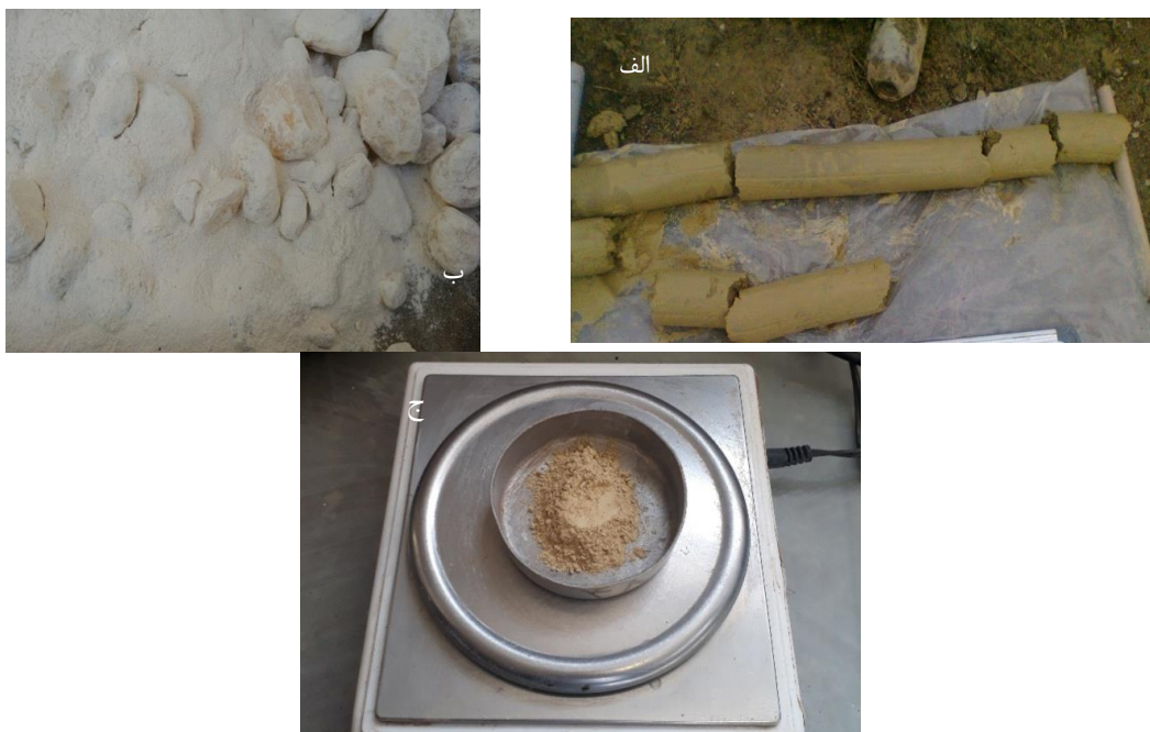
شکل ۱: مصالغ مورد استفاده در تحقق حاضر: الف- خاک رس، ب- پودر سنگ آهک، ج- نانو رس.
