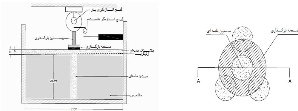
شکل ۴. شکل شماتیک جعبه و نمونه آزمایش.
