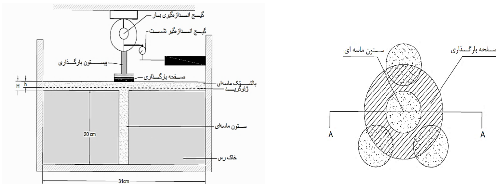
شکل ۴. شکل شماتیک جعبه و نمونه آزمایش.
