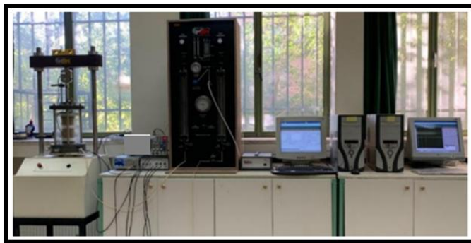
شکل ۶. تصویری از دستگاه سه‌محوری استفاده شده
