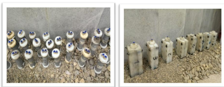
شکل ۵. محل نگهداری نمونه‌ها در ۲۴ ساعت اولیه
