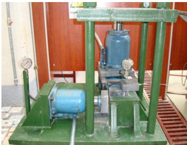
شکل ۸. نمایی از دستگاه سه محوره استفاده شده در نمونه‌های مکعبی
