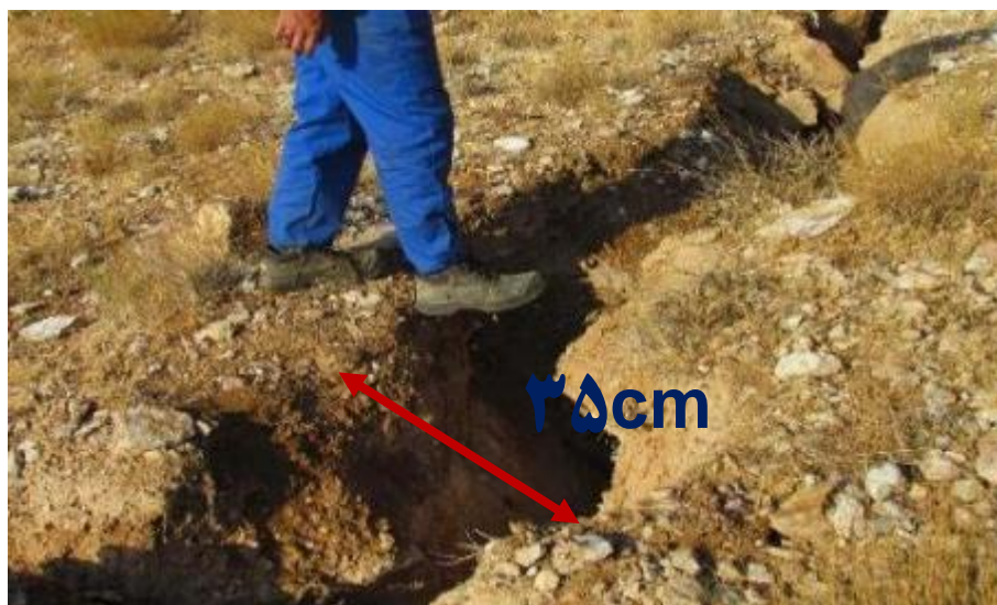
شکل ۱۶- نمونه درزه کششی در سنگ‌های شیستی معدن سنجد
