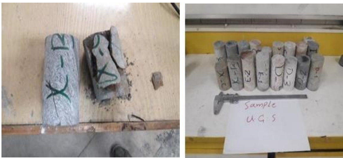
شکل شماره ۱۳- نمونه‌های انتخابی مقاومت فشاری تک محوری (سمت راست) نحوه شکست دو نمونه انتخابی (سمت چپ)
