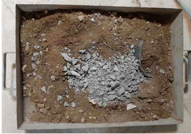
شکل ۲۲- اضافه کردن ۱۰٪ خرده بتن به پسماند ساختمانی
