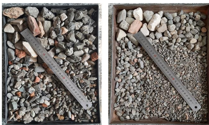
شکل ۹- نمونه‌ای از مصالح مورد مطالعه قبل و بعد از آزمایش لس آنجلس
