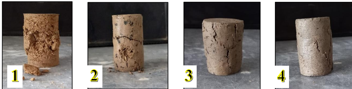
شکل ۸. نحوه شکست نمونه‌های خاک بدون افزودنی و مسلح شده با خاکستر پوسته بادام
