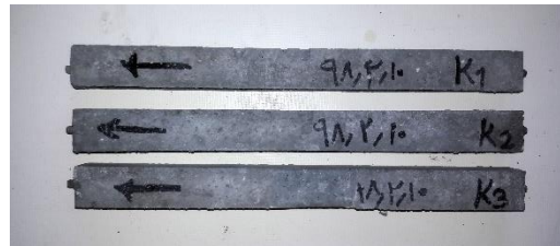
شکل ۲. ملاتهای منشوری تهیه شده از مصالح پایه برای آزمایش ASTM c 1260
