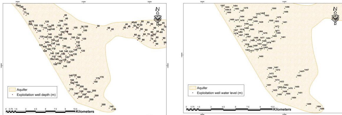
شکل ۱۲. موقعیت و عمق چاههای بهره‌برداری منطقه در بخش جنوب غربی آبخوان (شکل سمت چپ) و تراز سطح آب زیرزمینی چاههای بهره‌برداری با عمق بیش از ۹۰ متر در بخش جنوب غربی آبخوان (شکل سمت راست) بر اساس اطلاعات آخرین آماربرداری، اعداد بر حسب متر
