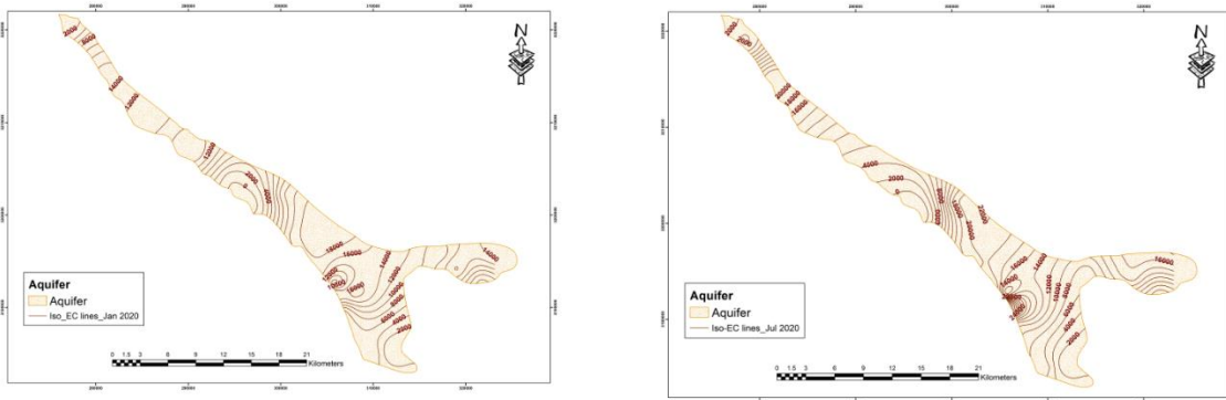
شکل ۸. خطوط هم هدایت الکتریکی آب زیرزمینی در زمستان ۱۳۹۸ (شکل سمت چپ) و تابستان ۱۳۹۹ (شکل سمت راست) بر حسب میکروموس بر سانتی‌متر در محدوده آبخوان
