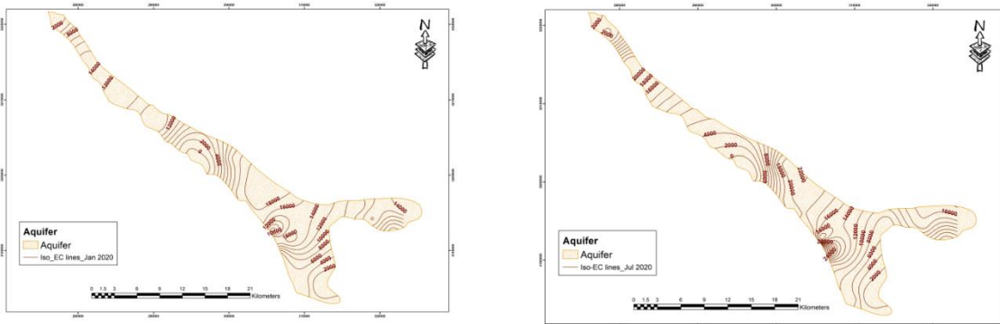
شکل ۸. خطوط هم هدایت الکتریکی آب زیرزمینی در زمستان ۱۳۹۸ (شکل سمت چپ) و تابستان ۱۳۹۹ (شکل سمت راست) بر حسب میکروموس بر سانتی‌متر در محدوده آبخوان
