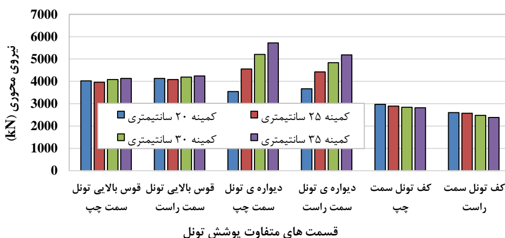
شکل ۱۳. کمینه مقادیر نیروی محوری در قسمت‌های متفاوت تونل با ضخامت متفاوت پوشش Fig. 13. Minimum axial force values in different parts of the tunnel with different coating thicknesses
