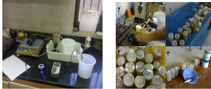
شکل ۶. مراحل آماده سازی نمونه‌ها (راست) و نحوه انجام آزمایش انحلال پذیری (چپ)
