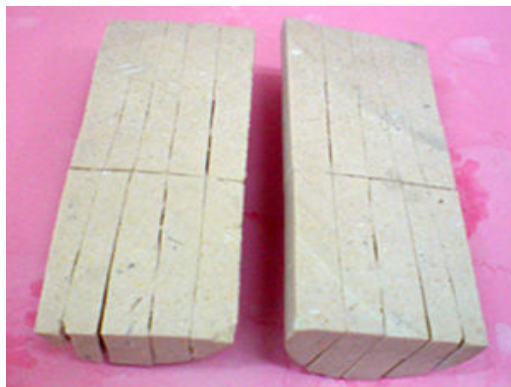
شکل ۵. نمونه دارای سه دسته ناپیوستگی متقاطع و عمود برهم، یکی دسته ناپیوستگی با زاویه ۹۰ درجه دارای ۴ ناپیوستگی موازی است و در جهت دسته قائم برای نمایش از وسط باز شده است.
