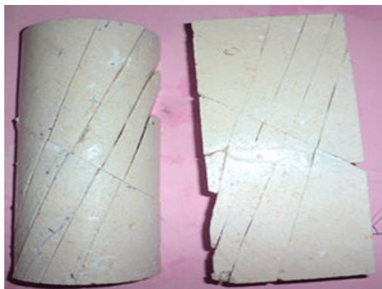
الف) نیم رخ ناپیوستگی‌ها در صفحه قائم در داخل نمونه ب) نیم رخ ناپیوستگی‌ها در جهت قائم در بیرون نمونه شکل ۴. نمونه دارای دو دسته ناپیوستگی عمود بر هم با زوایای ۳۰ و ۶۰ درجه و در جهت مخالف هم‌دیگر، دسته ناپیوستگی با زاویه ۶۰ درجه دارای ۴ ناپیوستگی موازی و نمونه در جهت دسته قائم برای نمایش از وسط جدا شده است.
