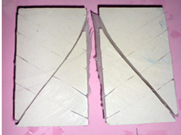
شکل ۲. دو دسته ناپیوستگی عمود بر هم دارای زوایای ۳۰ و ۶۰ درجه و در جهت مخالف هم‌دیگر، دسته ناپیوستگی با زاویه ۳۰ درجه دارای ۴ ناپیوستگی موازی و نمونه در جهت دسته قائم برای نمایش از وسط باز شده است.
