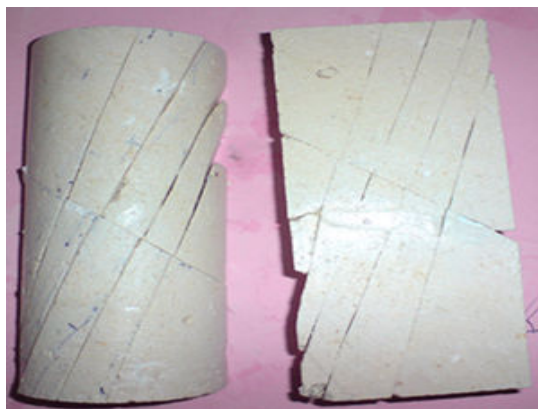
الف) نیم رخ ناپیوستگی‌ها در صفحه قائم در داخل نمونه ب) نیم رخ ناپیوستگی‌ها در جهت قائم در بیرون نمونه شکل ۴. نمونه دارای دو دسته ناپیوستگی عمود بر هم با زوایای ۳۰ و ۶۰ درجه و در جهت مخالف هم‌دیگر، دسته ناپیوستگی با زاویه ۶۰ درجه دارای ۴ ناپیوستگی موازی و نمونه در جهت دسته قائم برای نمایش از وسط جدا شده است.
