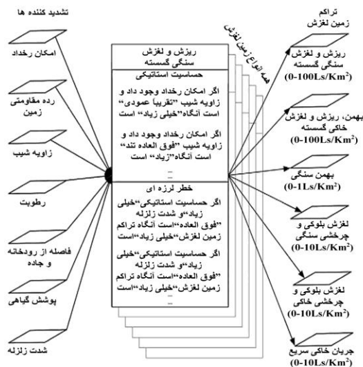
شکل ۱۱. نمودار جریانی داده‌ها برای بخش مقدار تراکم خطر کامل، معرف ورودی‌ها (اطلاعات تشدید کننده)، خروجی‌ها، و ترتیب قواعد [۱۱]، [۱۲]
