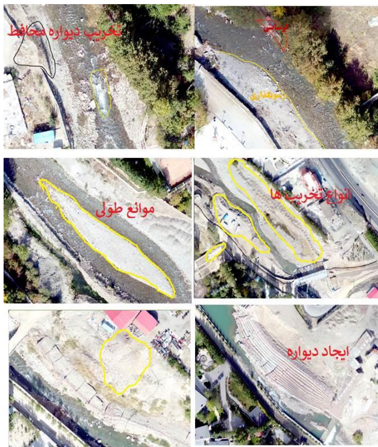
شکل (۱۱). رسوب گذاری و فرسایش در بازه ۴
