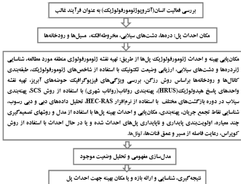
شکل (۴). فلوجارت مراحل بررسی ژئومورفولوژیک مکان‌یابی بیهنه و احداث پل‌ها در مسیل - روددره‌ها
