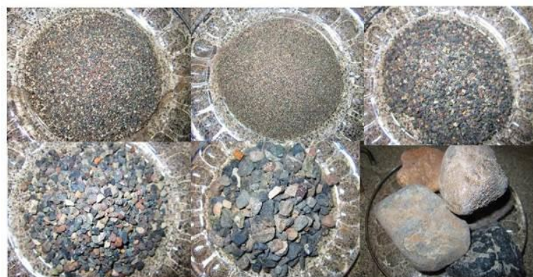
شکل (۳). تصاویری از آزمایشات دانه بندی از مخلوط سنگ و خاک
