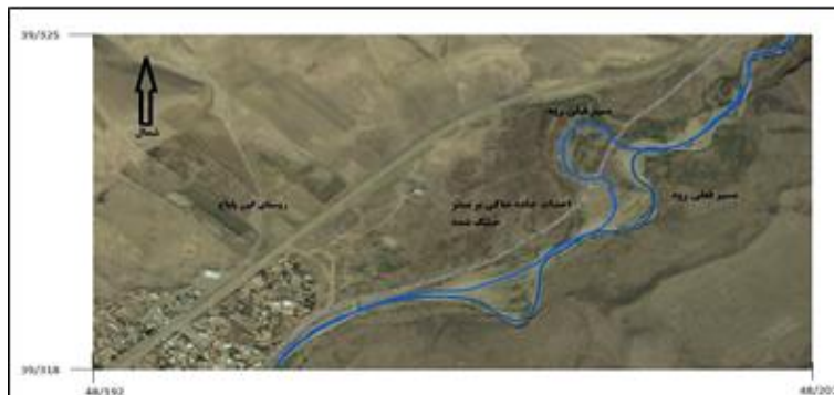
شکل (۴): احداث جاده خاکی در بستر خشک شده پیچان رود
