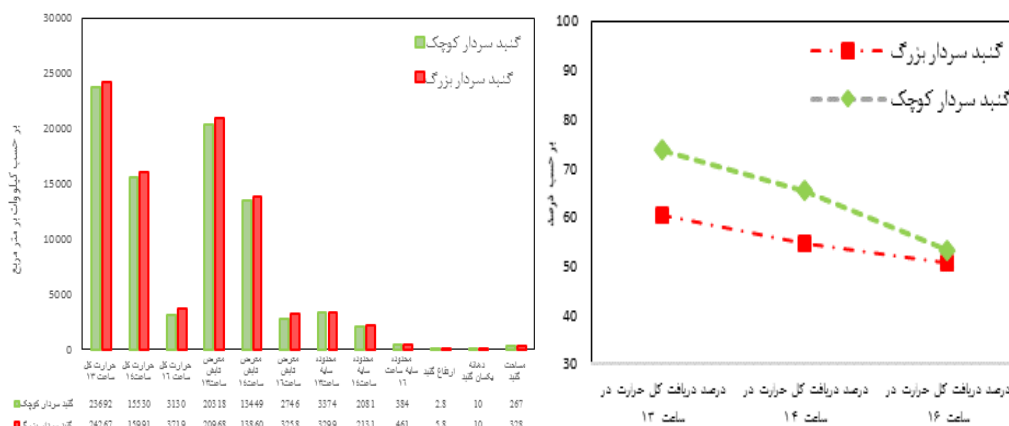
شکل (۸). نمودار از سمت چپ مربوط به میزان دریافت حرارت در معرض تابش، در محدوده‌ی سایه و حرارت کل گنبد آب‌انبارهای دهانه ثابت شهر قزوین در سردترین روز سال در ساعات ۱۳، ۱۴، ۱۶. نمودار از راست درصد میزان دریافت تابش خورشید بر سطوح گنبدهای با دهانه ثابت قزوین در ساعات ۱۴، ۱۶، ۱۸. منبع: نگارندگان.
