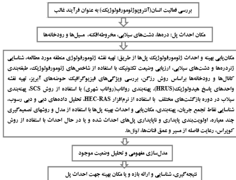
شکل (۴). فلوجارت مراحل بررسی ژئومورفولوژیک مکان‌یابی بهینه و احداث پل‌ها در مسیل - روددره‌ها
