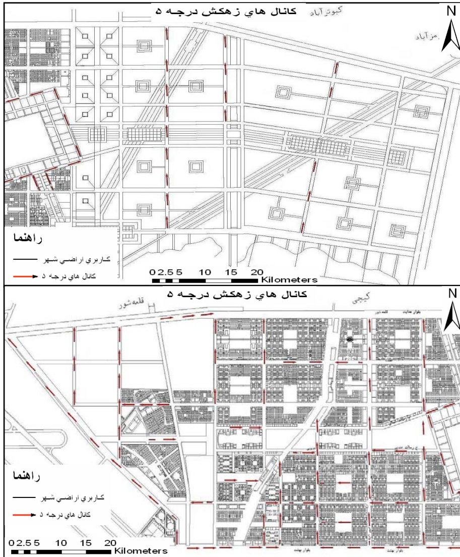
شکل (۸) کانال های زهکش شهری پیشنهادی درجه ۵: بخش شرقی و غربی بهارستان (منبع: نگارندگان)
