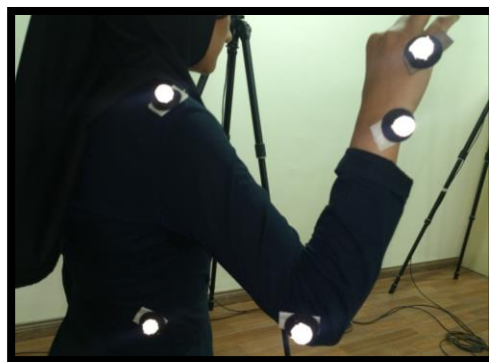
شکل ۲- نحوه اتصال مارکرها
