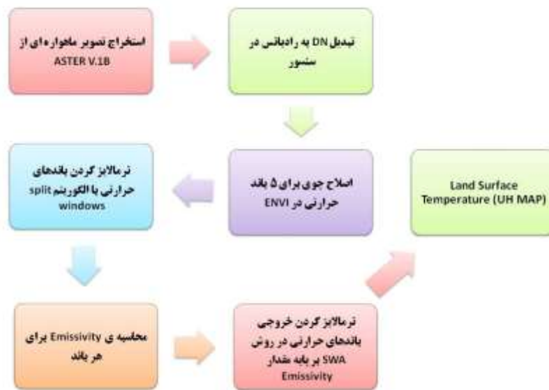
شکل ۳: فرآیند استخراج نقشه حرارت سطوح شهری با استفاده از تصویر ماهواره‌ای ASTER
