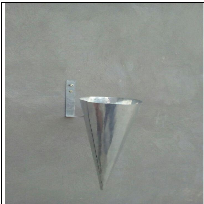
شکل ۲: ظروف مخروطی شکل رسوبگیر در مدارس
