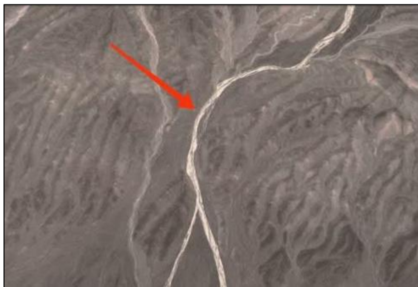
شکل ۷: پدیده حفر بستر یا آنته سه دانس در مسیر رودخانه میناخان
