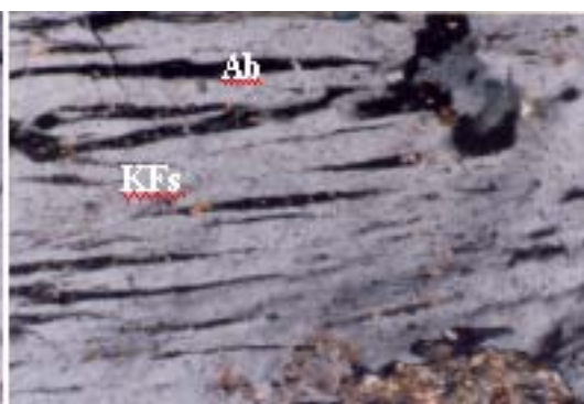
شکل ۸. نمایش بافت پرتیت (هم‌رشدی آلبیت و فلدسپات پتاسیک) در توده گرانیتی شمال موته ( \times 100.XPL ). فلدسپات پتاسیک = Kfs و آلبیت = Ab
