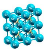
شکل ۱. الف) ساختار NaCl سولفید استرانسیوم
