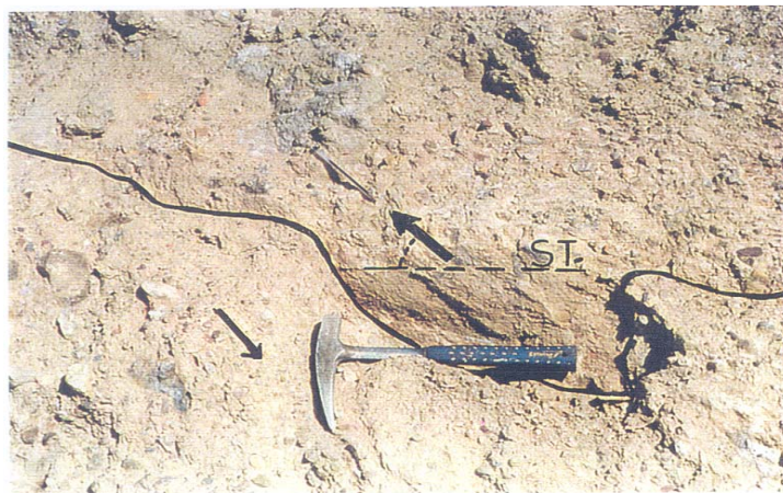
شکل ۱۰- ج) گسل جوان با موقعیت N 60 W / 80 / NE و زاویه ریک (\text{Rake}) 45 NW در بین رسوبات نیمه سخت شده واریزه و مخروط افکنه - ST : امتداد سطح گسل : جهت حرکت
