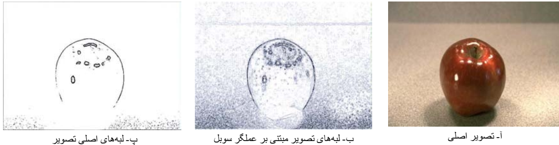
شکل ۴- مقایسه بین لبه‌های مبتنی بر عملگر سوپل و اصلی یک تصویر نمونه
