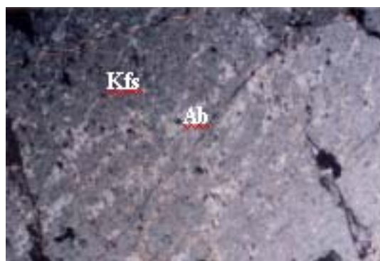
شکل ۹. هم‌رشدی‌های پرتیتی (سرد شدن و اختلاط ناپذیری) در گرانیت‌های شمال موته ( \times 100.XPL ). فلدسپات پتاسیک = Kfs و آلبیت = Ab
