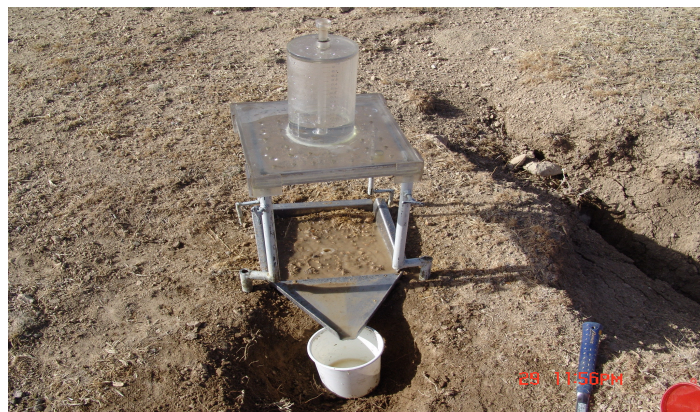
شکل ۲. تصویر دستگاه باران‌ساز کوچک و اجزای تشکیل دهنده آن
