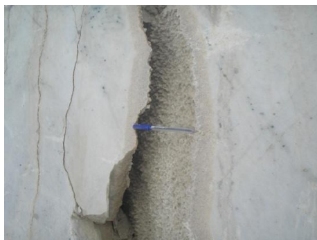
شکل ۸. تصویری از درز J10، این درز دارای دو نسل پرشدگی است و در حال حاضر در حال باز شدن است
