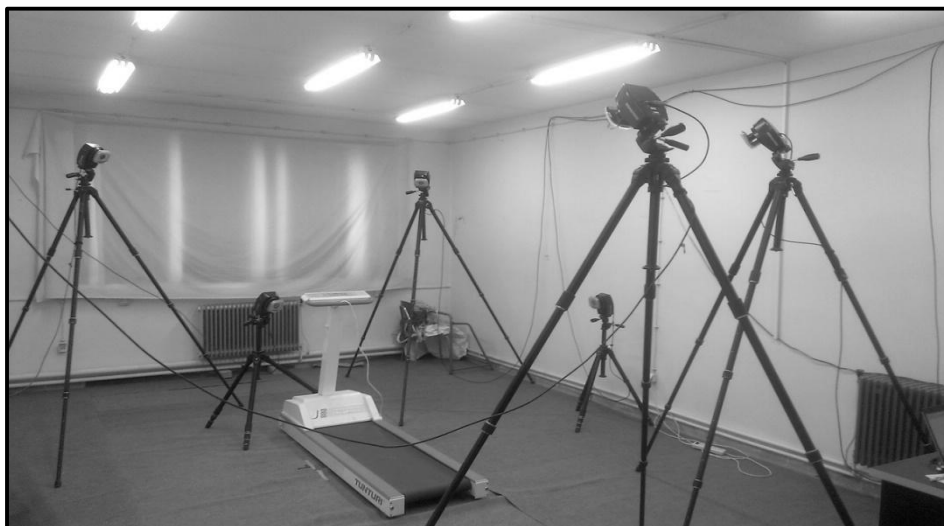
شکل ۱. موقعیت شش دوربین اپتوالکترونیک نسبت به تردمیل
