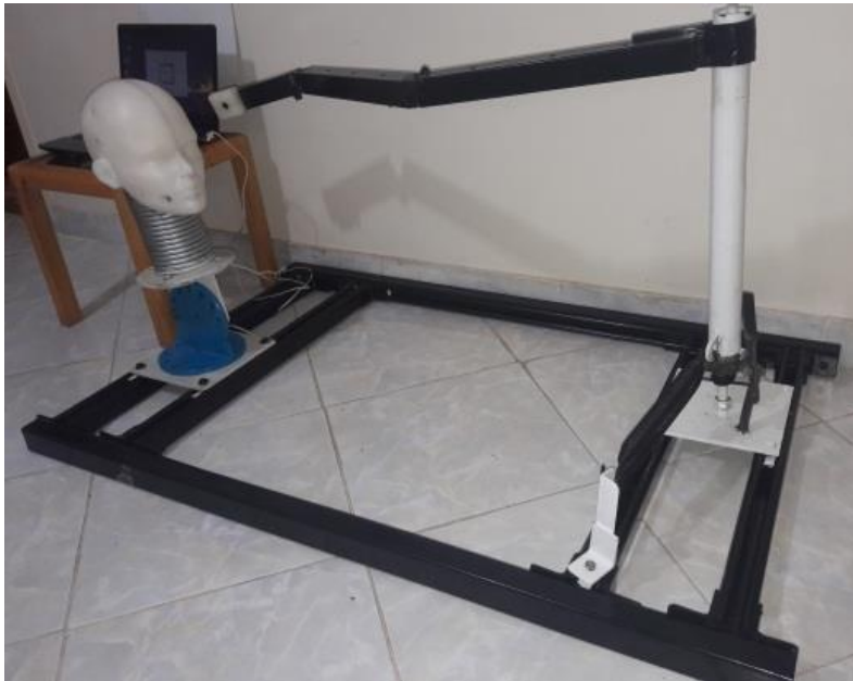
شکل ۳- مجموعه دستگاه آزمایش ضربه به سر ثبت شده از سوی پژوهشگران
