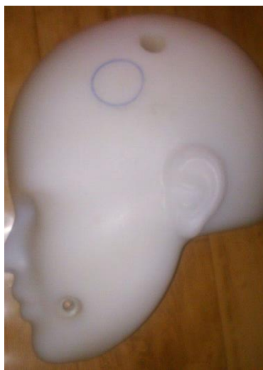
شکل ۲. مدل ساخته شده سر توسط دستگاه CNC
