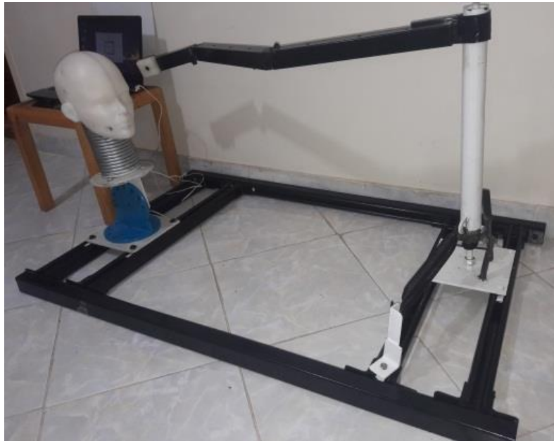
شکل ۳- مجموعه دستگاه آزمایش ضربه به سر ثبت شده از سوی پژوهشگران
