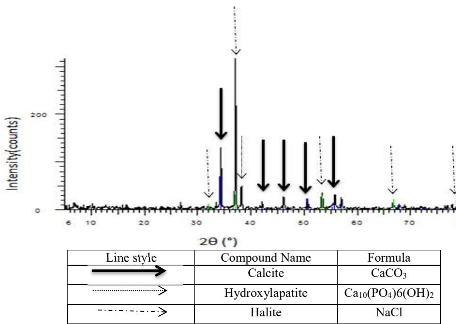
شکل ۵- الگوی پراکنش ایکس رسوب ایجاد شده از جایه ۶ روی محیط رسوبی حاوی ۱۰ درصد نمک.
