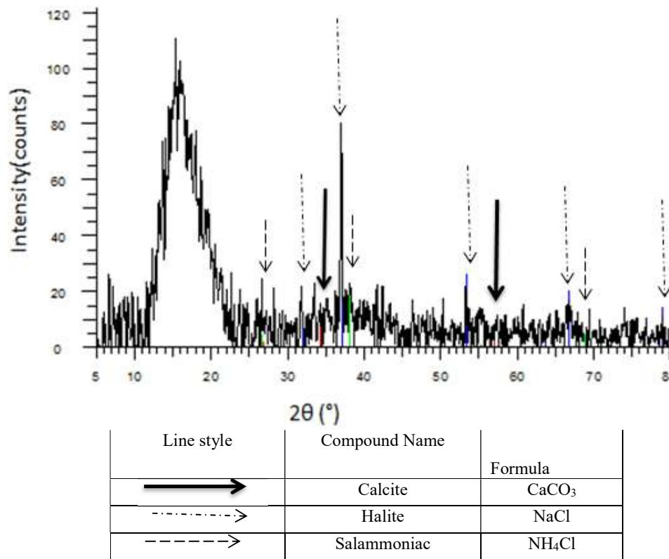
شکل ۴- الگوی پراکنش ایکس رسوب ایجاد شده از جایه ۶ بر روی محیط رسوبی حاوی ۵ درصد نمک.
