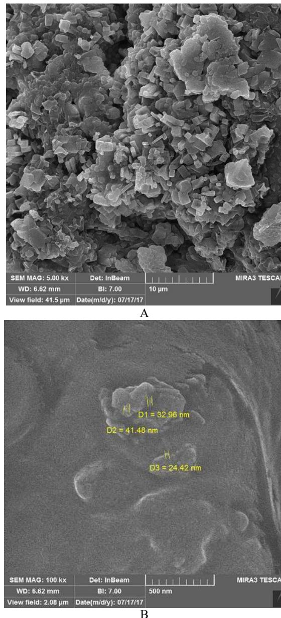
شکل ۶- تصاویر SEM از تجمعات کریستالها تولید شده توسط جدایه ۶ بر روی سطوح باکتری در محیط رسوبی با بزرگنمایی‌های مختلف.
