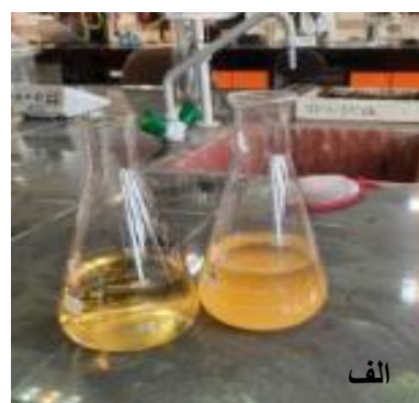
شکل ۱- الف: تغییر رنگ محلول استخراجی پس از سنتز نانو ذرات نقره با استفاده از آن محلول ب: نتایج TEM نانو ذرات نقره سنتز شده
